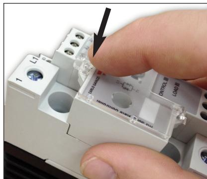
2: Encajar la cubierta transparente en la ranura de la parte superior de la unidad RGx1P
