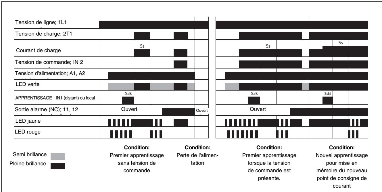
La procédure d'apprentissage peut être exécutée localement ou à distance. Pour l'apprentissage local, appuyer sur le bouton TEACH en face avant du relais pendant au moins 3 secondes (mais moins de 5 secondes). On peut exécuter l'apprentissage à distance en appliquant un signal de haut niveau à la borne IN 1 pendant au moins 3 secondes (mais moins de 5 secondes).
