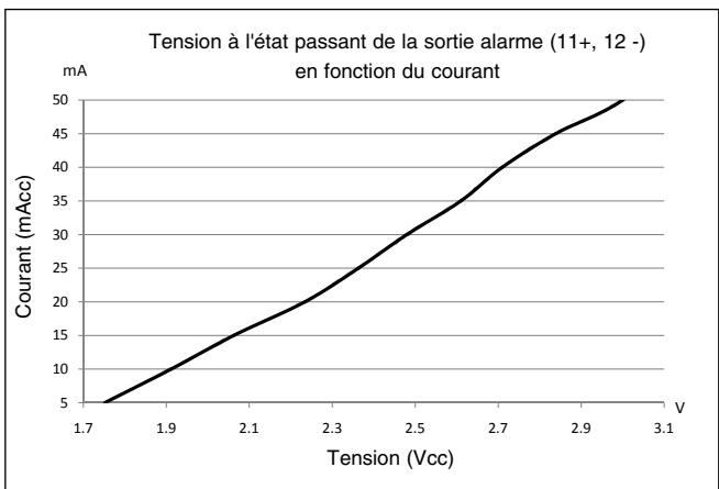
5: Tension de commande CC à alimenter par une source de Catégorie 2
