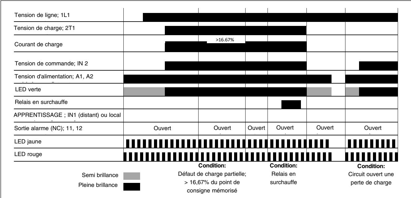
Lors de l'application de la tension d'alimentation, les LED jaune et verte clignotent l'une après l'autre en continu, indiquant qu'aucun point de consigne de courant n'est mémorisé dans le relais. La LED verte est allumée en fixe en semi brillance indiquant la présence de la tension d'alimentation.
