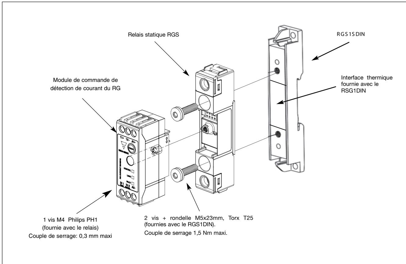
Serrer progressivement les 2 vis du module de puissance RG (en alternant une vis sur deux) jusqu'à obtention d'un couple de serrage de 1,5Nm.
