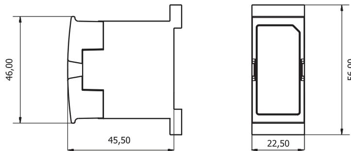
**Fig. 5 Integrador (mm)**
