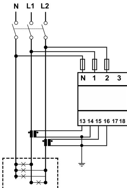
Fig. 6 Sistema bifásico con neutro (3 hilos)
