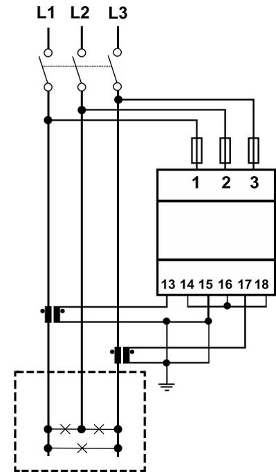
Fig. 5 Trifásico sin neutro (3 hilos). MID
