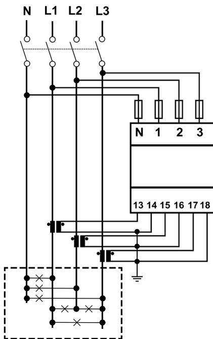
Fig. 3 Trifásico con neutro (4 hilos). MID
