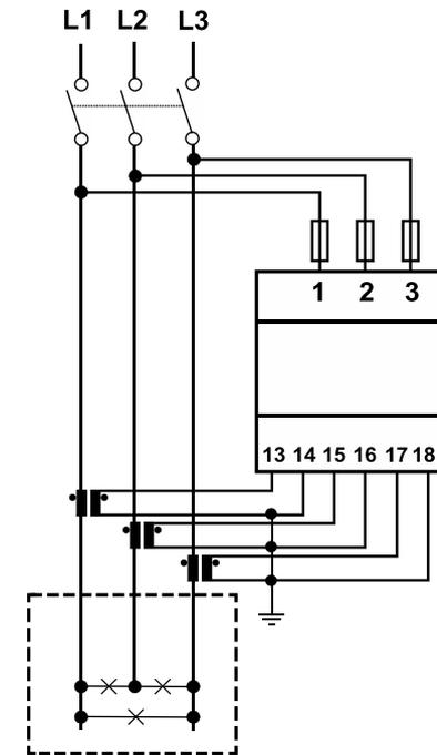
Fig. 4 Trifásico sin neutro (3 hilos)
